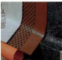
Fourniture et mise en œuvre d'un drain au droit des semelles de fondation permettant la protection d'infrastructure depuis la cunette béton armé et sur une hauteur de 1,50 m environ (prévoir un recouvrement avec le système d'étanchéité murale enterrée prévue à l'étanchéité), réalisée avec des plaques synthétiques gaufrées de 600 microns ou plaques cellulo-minérales avec protection supérieure.
